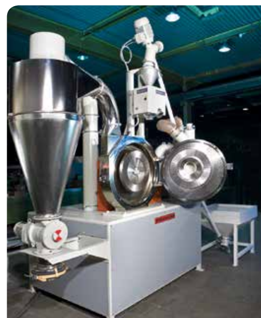
Rys. 1. Kompaktowa zabudowa układu pulweryzacji z młynem tarczowym PolyGrinder Original Pallmann PM300
